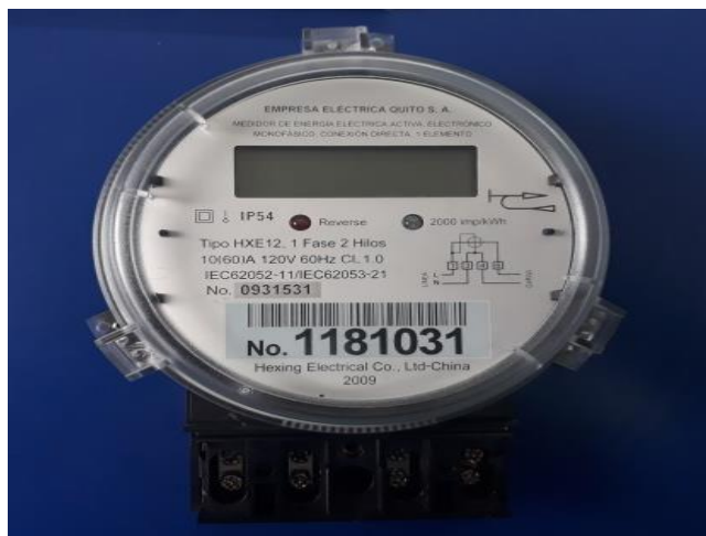
Figura. 37 Medidor de Energía Eléctrica
