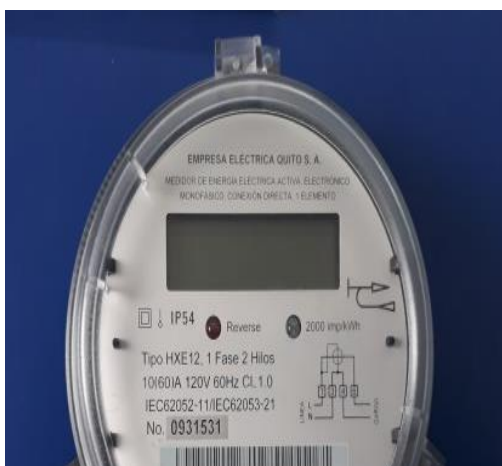
Figura.29. Display apagado Infracción al servicio (EEQ, 2014)
