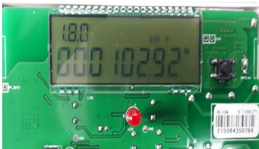
Figura. 88. Led de impulsos Led de Contrastación (EEQ, 2017)
