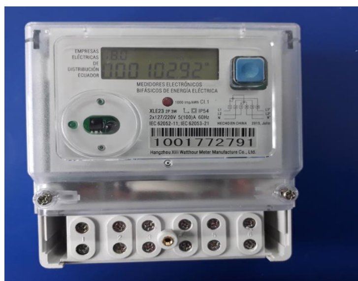
Figura. 44. Medidor electrónico Contador de Energía Eléctrica (electrónico, 2017)
