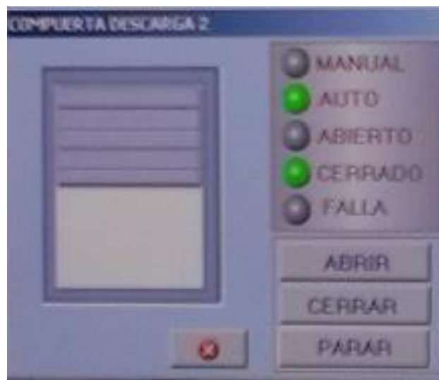
Figura 81. Operación de la compuerta en la posición automática
