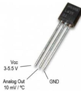
Figura 1.13 Sensor de temperatura LM35 Fuente: (LLamas, 2015)
