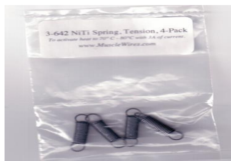
Figura 1.7 Resorte de aleación de memoria de forma Nitinol Fuente. Elaborado por el autor
