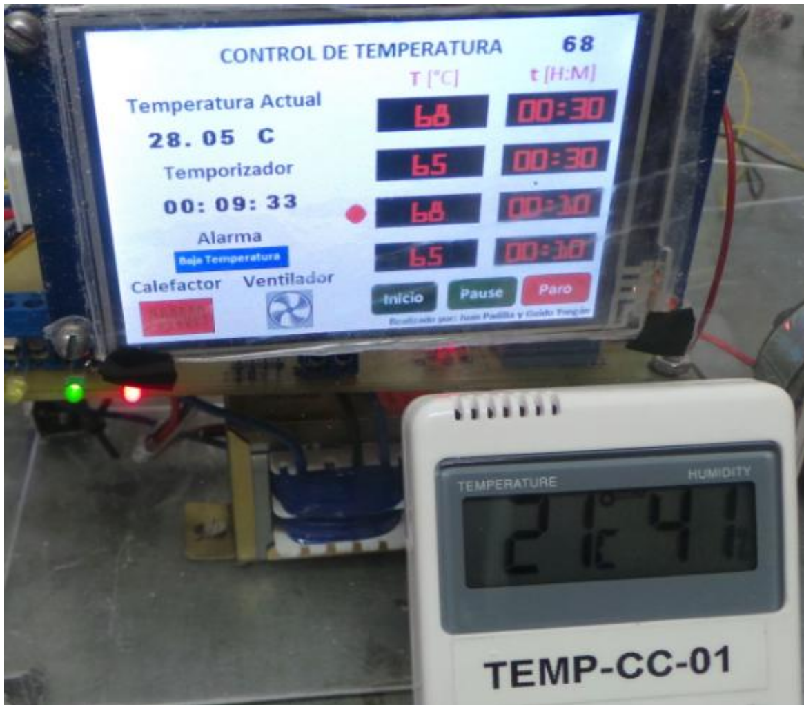
Gráfico 48.- Prueba de Comunicación de la Tarjeta con Elementos de Entrada y Salida
