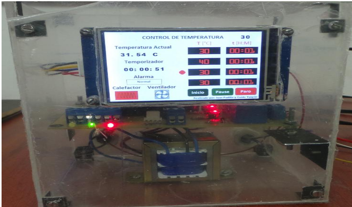
Gráfico 49.- Circuito Montado en una Caja de Acrílico
