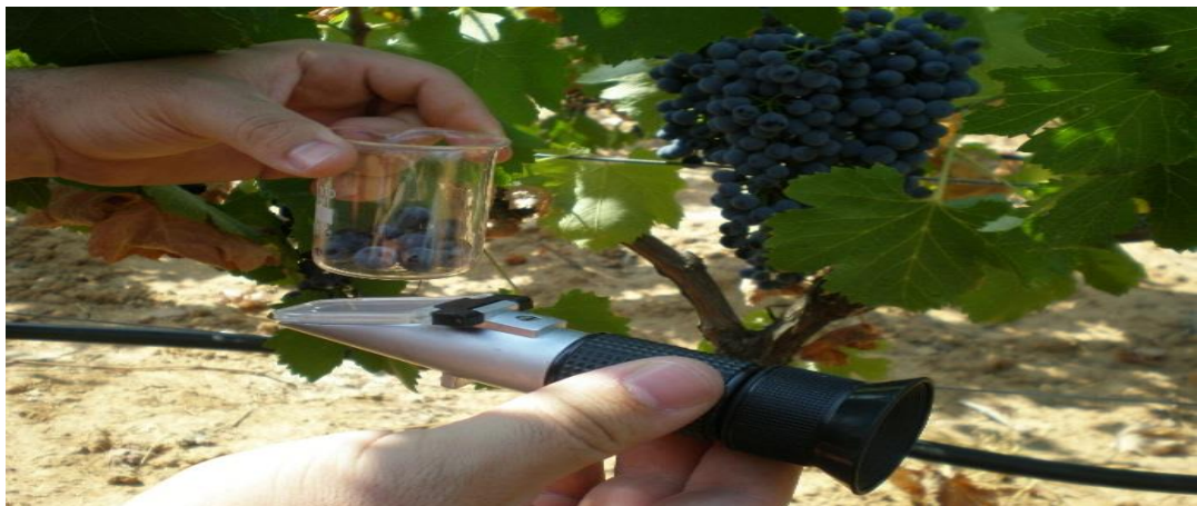
Figura 5 Refractómetro de campo utilizado en viñedos
