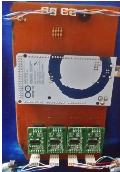
Figura 15. Placa superior del circuito montada los componentes
