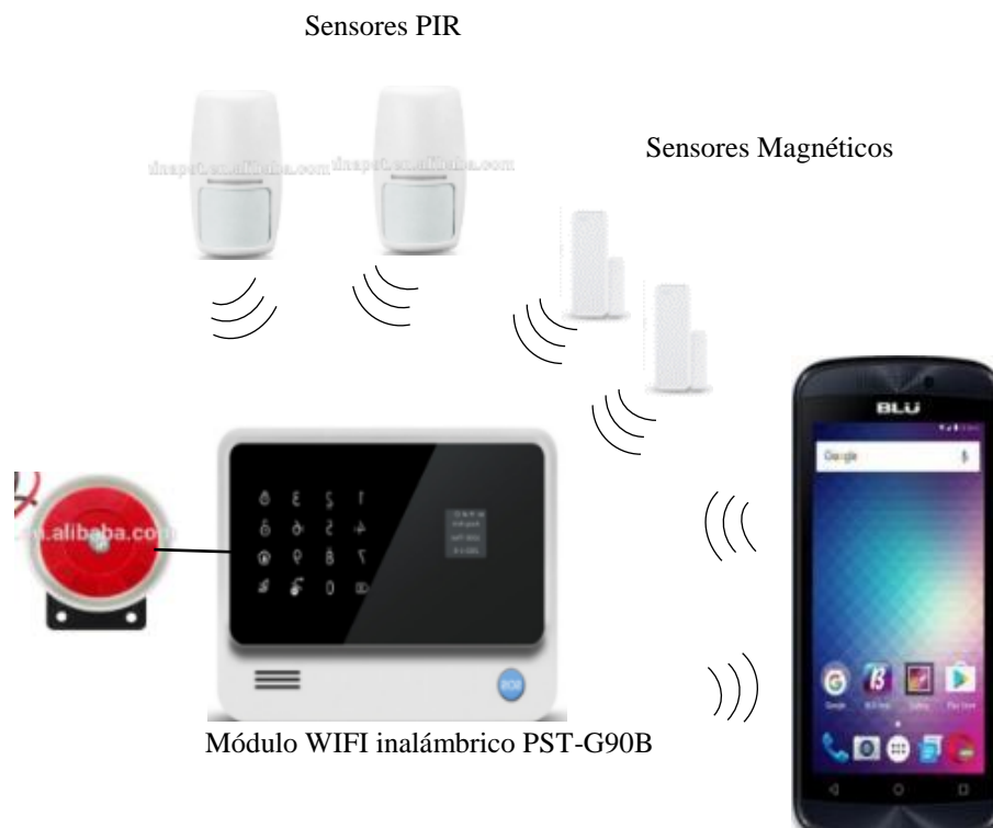
Figura 23. Diagrama funcional del sistema de Alarmas.
