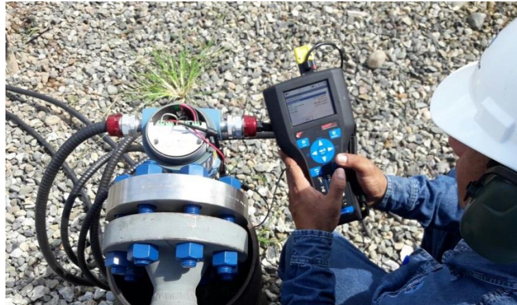
Imagen 61: Configuración comunicador 475 Hart
