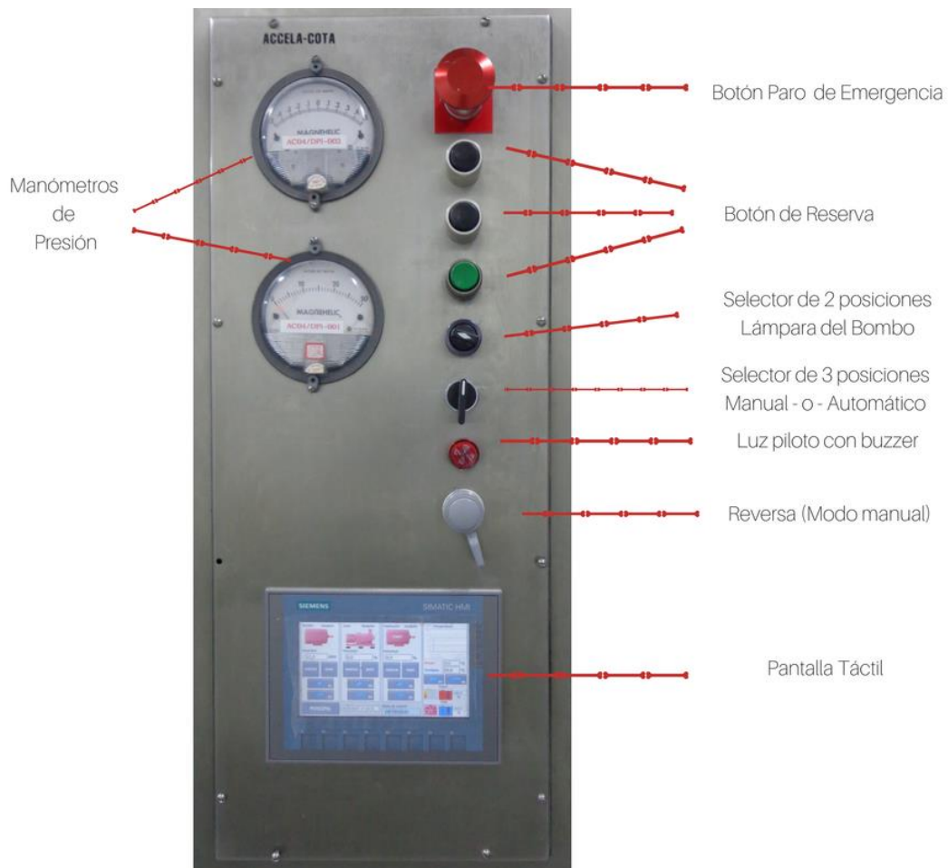
Figura 59 - Partes de la botonera del bombo de laqueado ACCELA COTA
