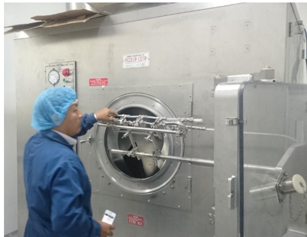
Figura 66 - Mantenimiento de pistolas de pulverización
