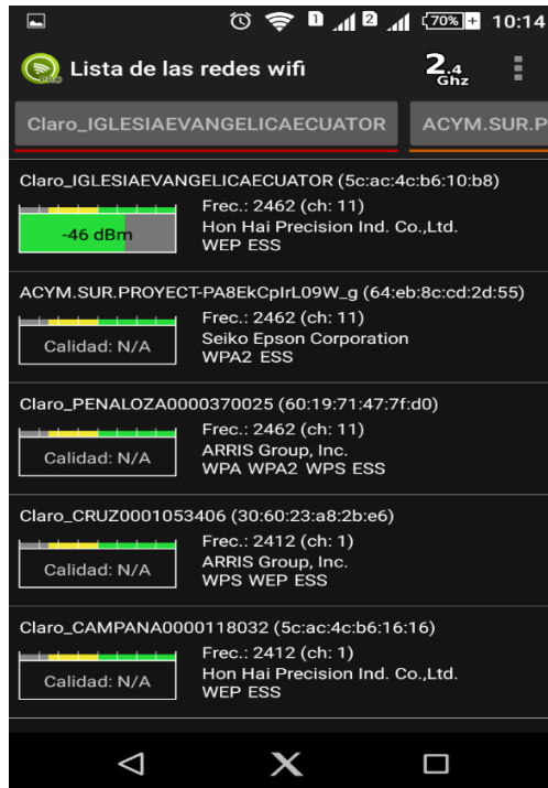
Figura 15: Medición de potencia de señal wlan en púlpito de la iglesia ACYM SUR
