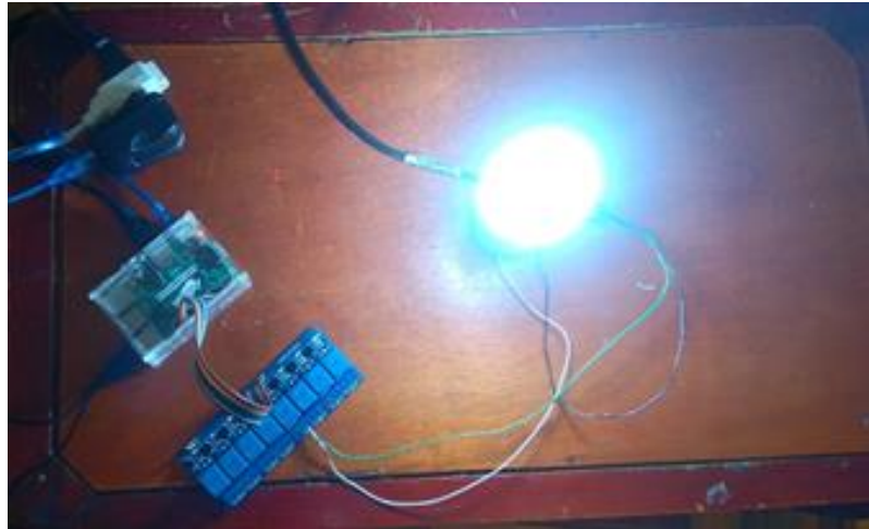
Figura 14: Encendido de una lámpara con relés y puerto GPIO
