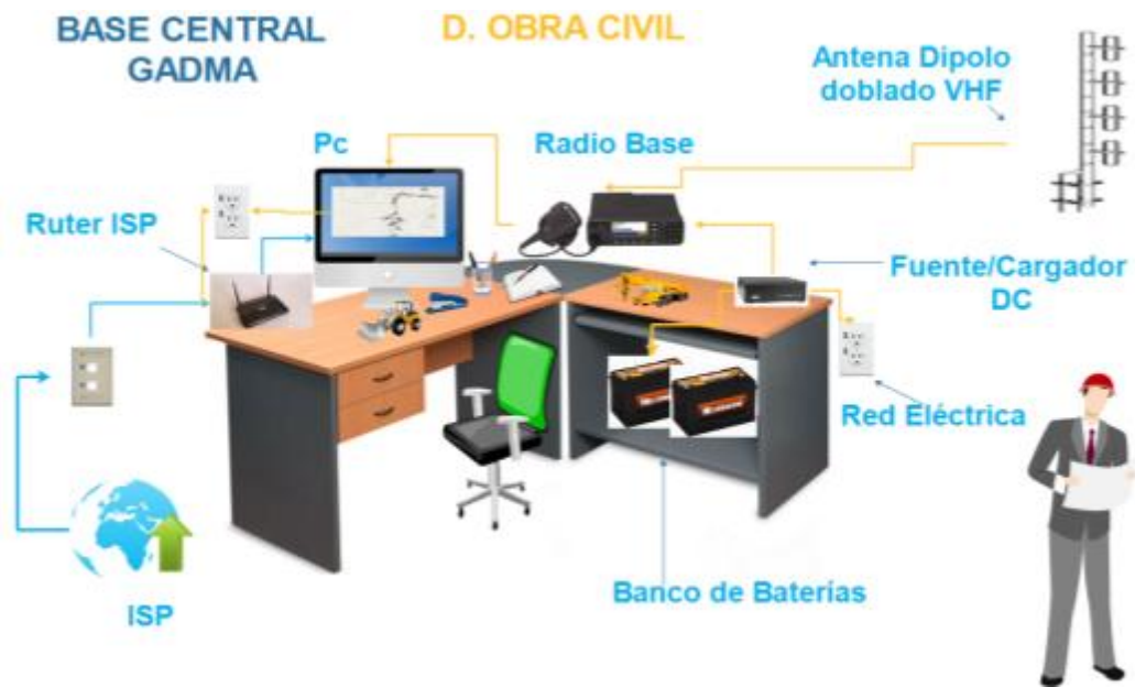
Figura 3.29 Conexión de equipos con sistema de Respaldo en GADMA.
