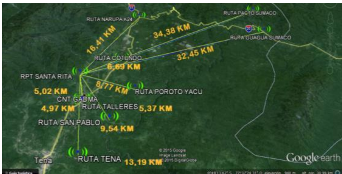
Figura 3.4 Distancias entre los puntos SITIO-REPETIDORA.
