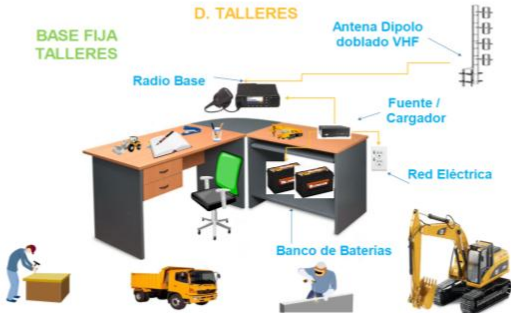
Figura 3.30 Conexión de equipos con sistema de Respaldo en Talleres M.
