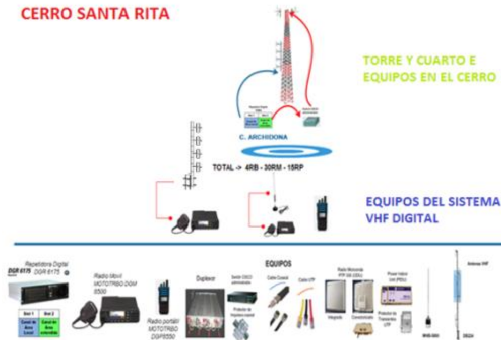
Figura 3.27 Estructura y equipos de red del sistema VHF digital.
