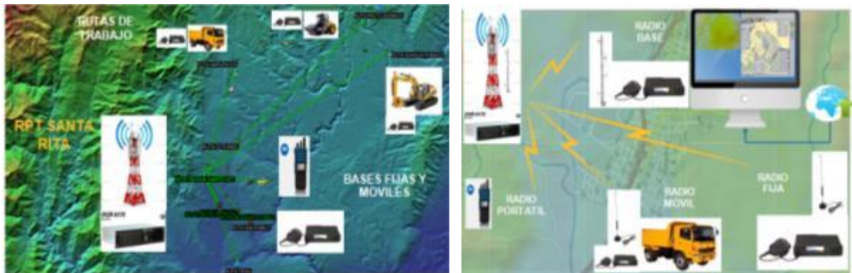
Figura 3.26 Topología de red del sistema VHF digital.
