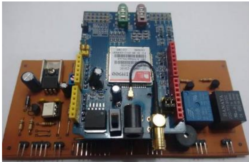
Figura 25 Interconexión Placa base con módulo Arduino Uno
