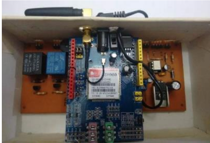
Figura 26 Interconexión Arduino Uno - Sim900 y placa de control
