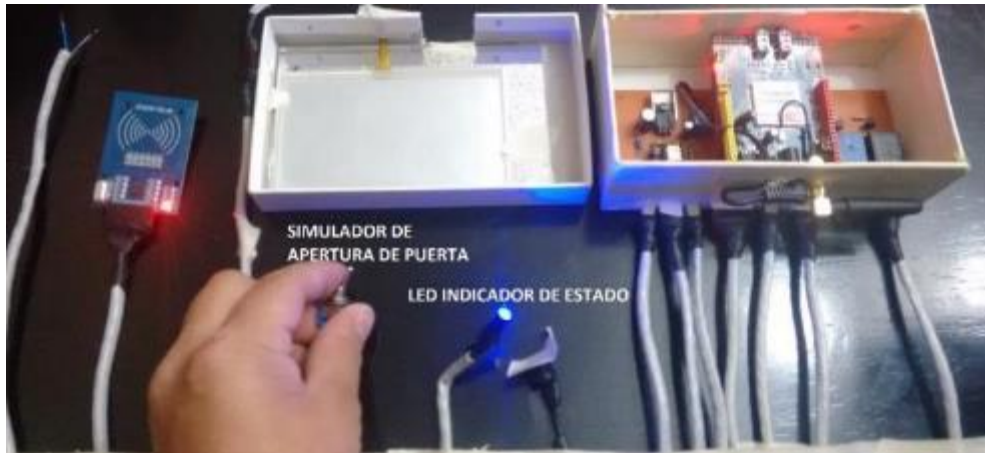
Figura 31 Sensor de apertura y cierre de puerta del automóvil
