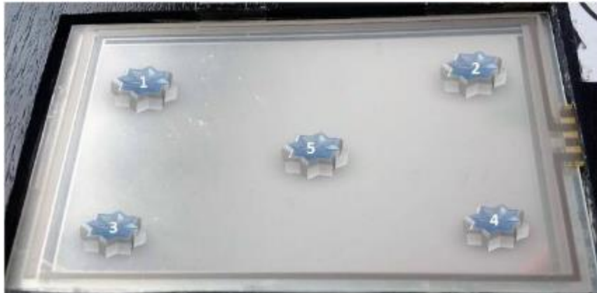
Figura 15 Pantalla Resistiva de 4 hilos / 5,7 pulgadas.
