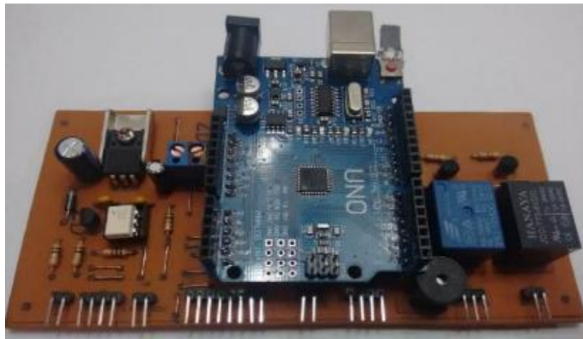
Figura 24 Interconexión Placa base con módulo Arduino Uno
