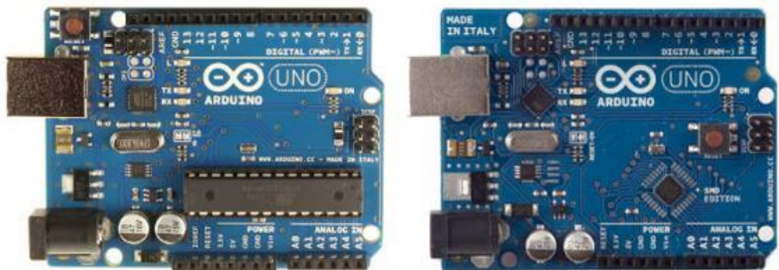
Figura 1 Arduino Uno con microcontrolador en formato DIP y SMD
