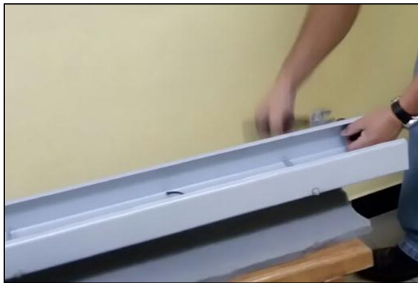
Figura 21: Bandeja portacables o canaleta metálica
