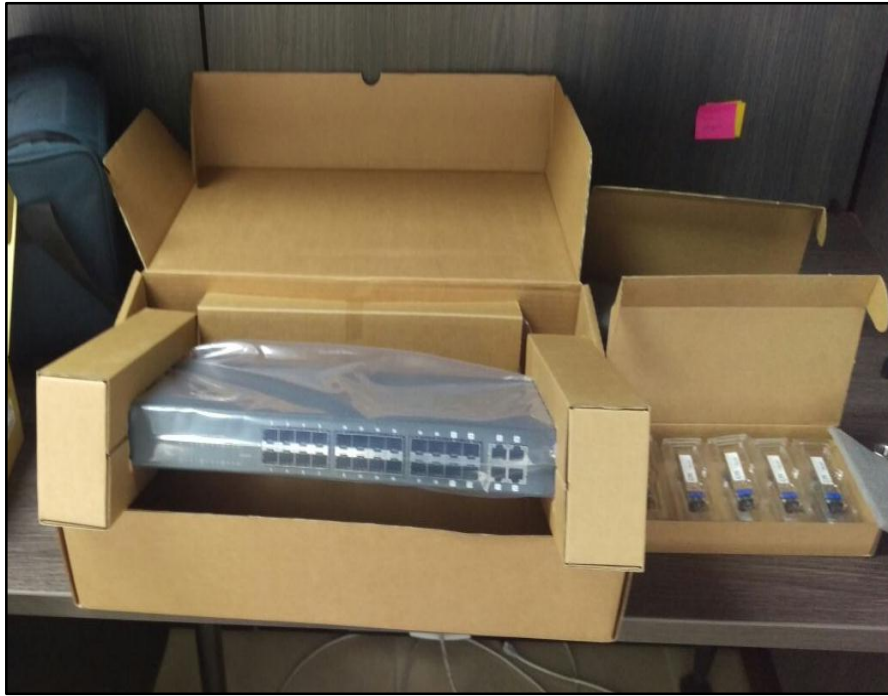
Figura 52: Switch CTC de 24 puertos
