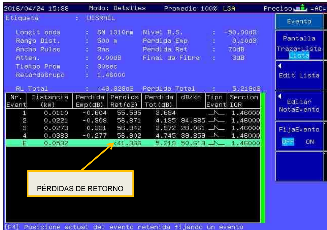
Figura 70: Pantalla de pérdidas correspondiente a la fibras A y B del aula 310
