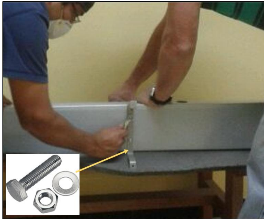
Figura 25: Pernos de 15 mm x 8mm con tuercas y rodela
