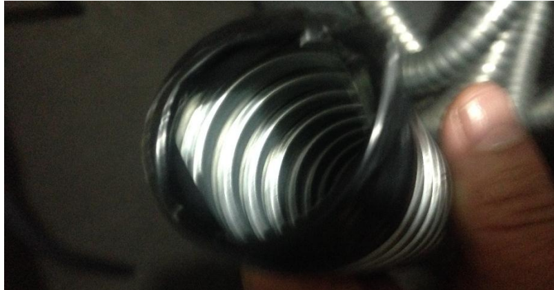
Figura 45: Protección en los fillos de la manguera BX Fuente: Universidad Tecnológica Israel
