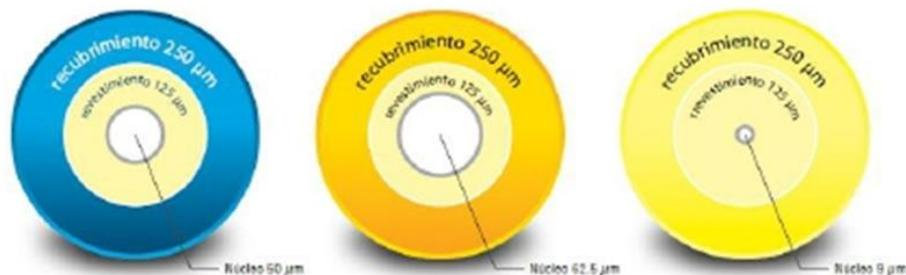
Figura 3 Tipos de núcleo de fibra óptica
