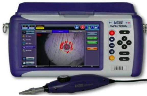
Figura 11 Fibroscopio que visualizar la superficie del conector
