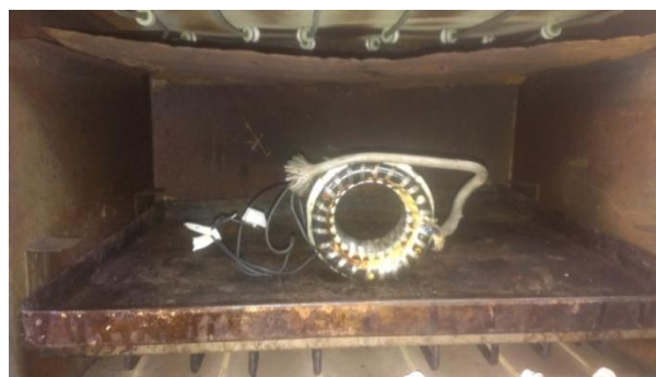
Figura 3.3 Estator dentro del deshumidificador
