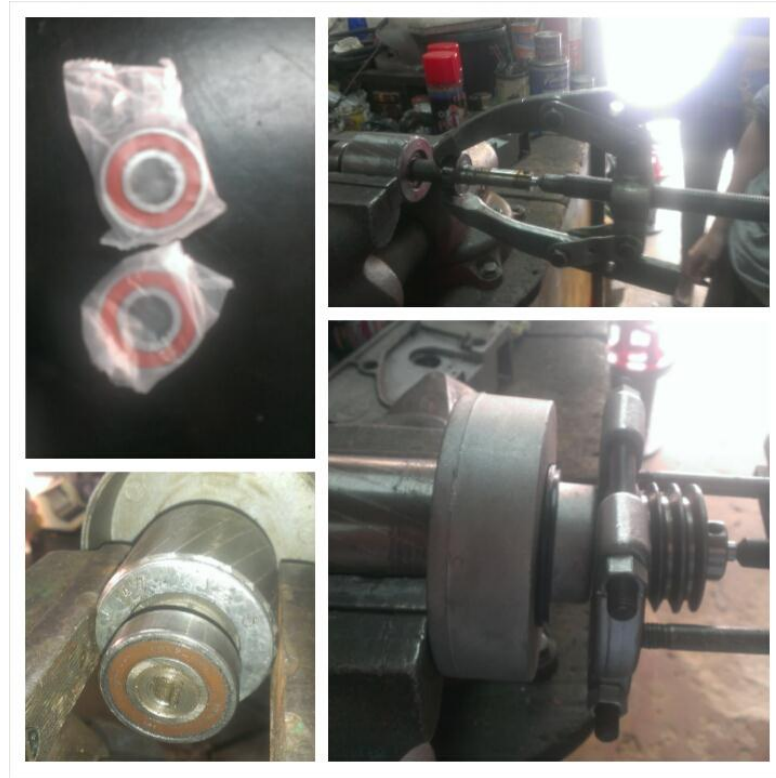
Figura 3.4 Cambio de partes (Bocín y Rodamientos)
