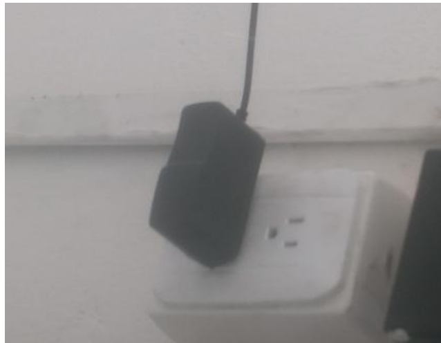
Figura 3.17 Toma de energía y adaptador de la placa Arduino
