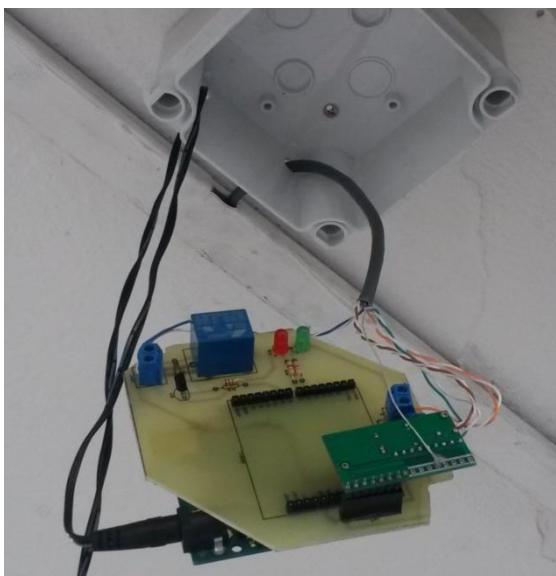
Figura 3.18 Colocación de los dispositivos en la caja hermética
