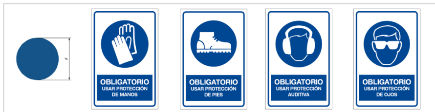
Imagen 22 Rótulos señal obligatoriedad
