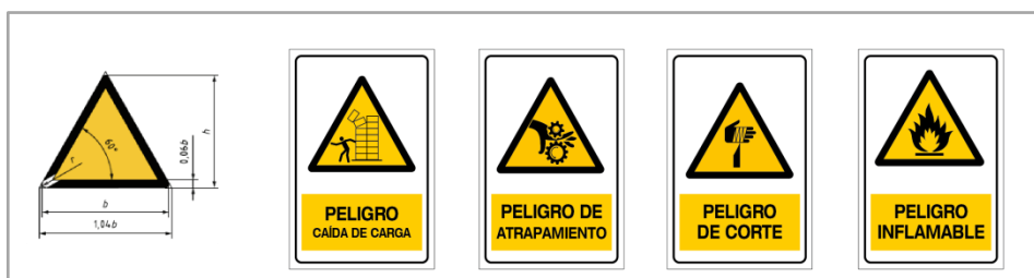
Imagen 23 Rótulos señal de peligro
