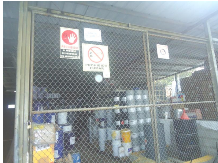
Imagen 3 Poca visibilidad del identificador de área Desorden en los rótulos de las señales, no cumple con los estándares de la señalética industrial.
