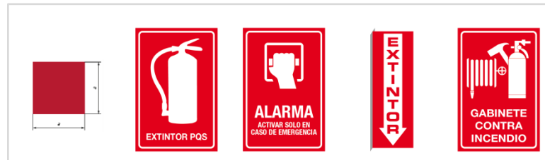
Imagen 25 Rótulos señal equipo contra incendio
